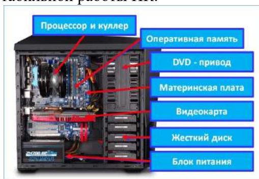
Рис. 1.1. Схема персонального компьютера.
